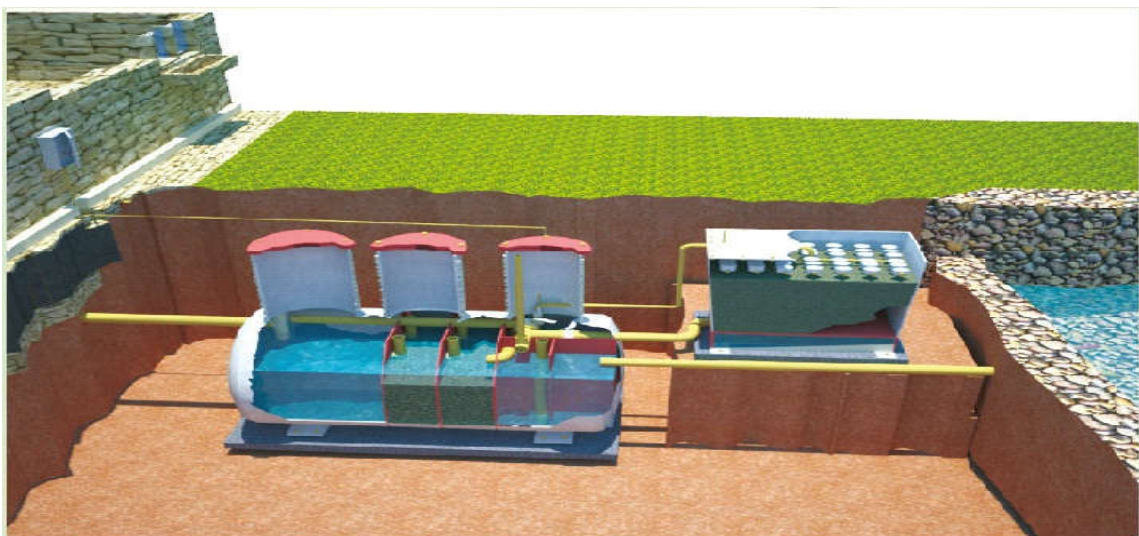
Hình 3.4 Sơ đồ cấu tạo bể XLNT hợp khối bằng vật liệu Composite
